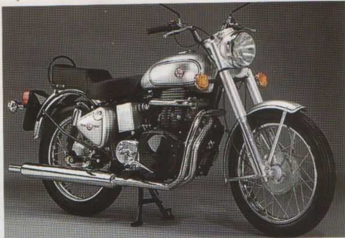
Enfield Centaurus 850 - ropák dvouválec, 20 HP při 3600 ot/min
