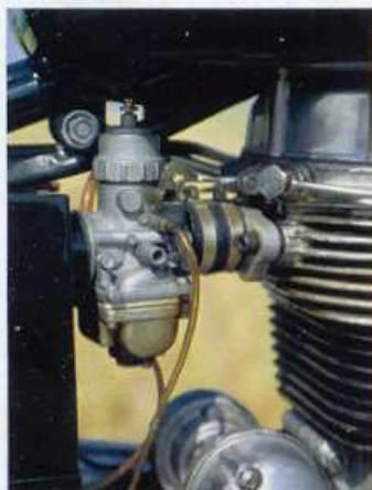
Jediný karburátor nasává přes kovový masný vzduchový čistič.
