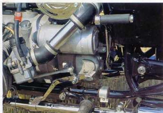
Čistič vzduchu Uralu Vik je už vybaven papírovou vložkou. Pod ním je umístěn spouštěč.
